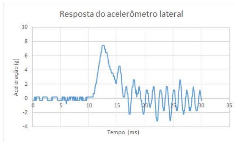
Figura 3.13: Aceleração esquerda do ensaio de impacto do Capacete “Exemplo”, a 6 m/s, impacto do topo do capacete, contra bigorna plana, retirado de [24]
