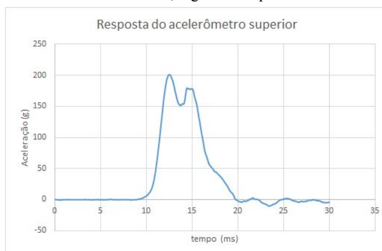
Figura 3.11: Aceleração Vertical do ensaio de impacto do Capacete “Exemplo”, a 6 m/s, impacto do topo do capacete, contra bigorna plana, retirado de [24]
